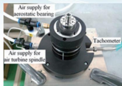
図1：エアタービンスピンドルの回転制御
