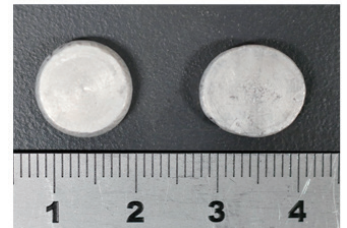
図4: 加工後の横断面形状 (左: 揺動なし, 右: 揺動あり)
