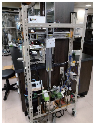
熱サイクル試験装置 ( -55\sim+60^{\circ}\text{C} 、20min サイクル、常圧)
