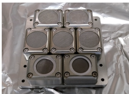
「たんぽぽ4」で曝露後に地球帰還した曝露ユニットの全体像
