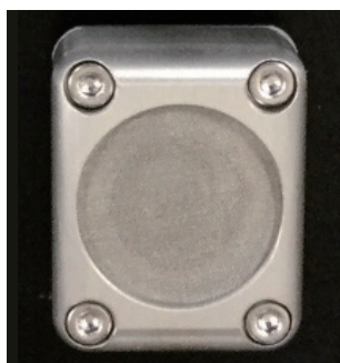
「たんぽぽ5」で核酸合成を目指した水溶液曝露用実験装置
