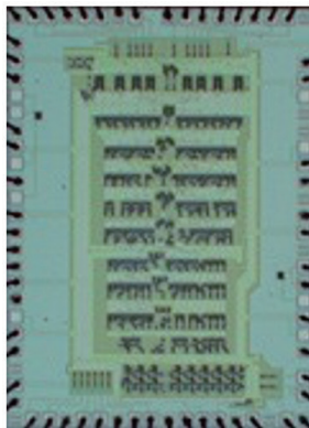
図1: 金属系超伝導体（ニオブ）を用いた超伝導集積回路（4x4ビット並列除算器）
