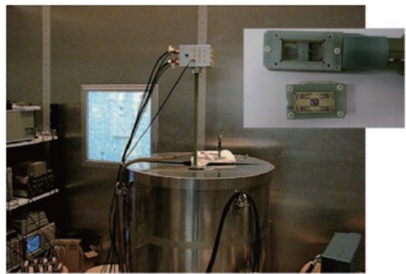
図2: 極低温（液体ヘリウム）下での超伝導チップの計測
